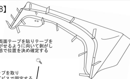
図を参考に両面テープを貼りテープを各所から剥がせるように向いて剥がし紙出した状態で位置を決め確定する
